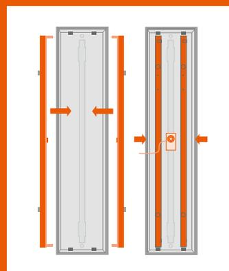
LINEAR MAGNETIC BATTEN T5 mit Hilfe der Magnetbefestigung einsetzen und mit der werkzeuglosen CONNECTOR BOX an die Stromversorgung anschließen
